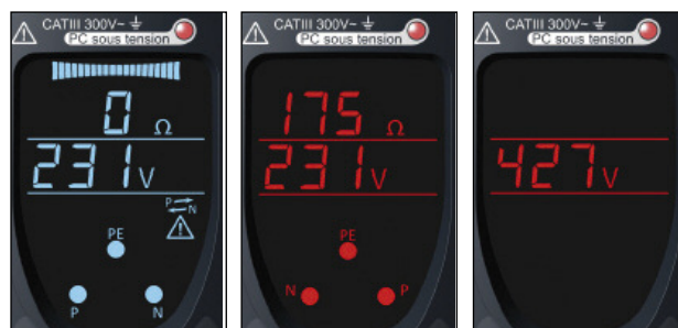
Prise mal câblée: phase présente sur PE
