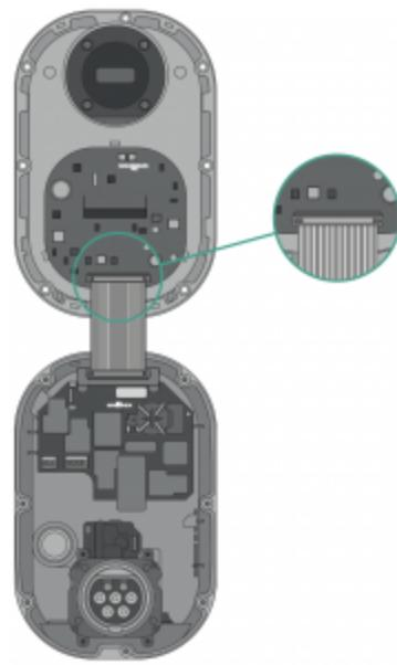
7. Détachez avec précaution le câble plat du couvercle en appuyant sur les loquets latéraux. Mettre le couvercle de côté.
