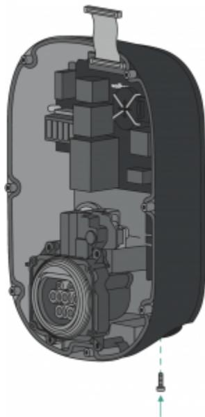
3. Faites une incision sur le passe-fil inférieur et insérez le câble d'alimentation. S'assurer que le passe-fil est entièrement étanche lors de l'insertion du câble d'alimentation.
