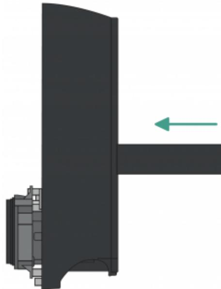
1. Faites une incision sur le passe-fil arrière et insérez le câble d'alimentation. S'assurer que le passe-fil est entièrement étanche lors de l'insertion du câble d'alimentation.
