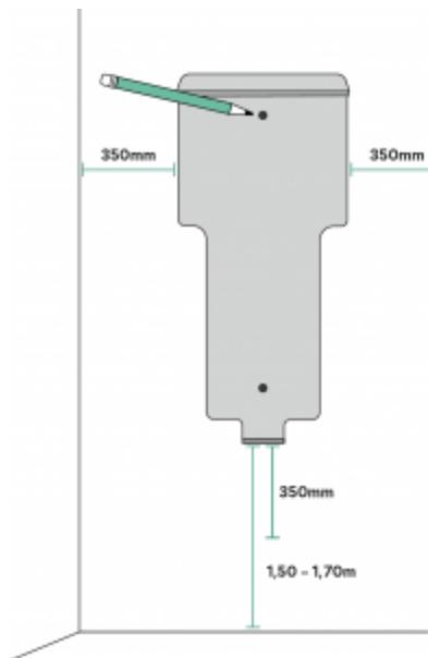
2. Placer la plaque murale bien droite. Utilisez un crayon, un mètre et un niveau à bulle pour marquer la position des vis.
