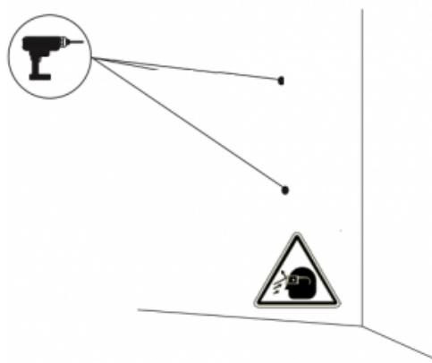
3. Percez trois trous à l'aide d'une mèche de taille appropriée. Placer la plaque murale dans l'alignement des trous. Si vous installez votre chargeur sur un mur solide, utilisez les ancrages muraux fournis.
